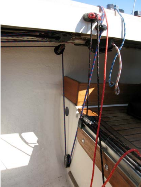
Babords fin och grovjustering av backstag är placerade något framför storskotsvagnens justering.
