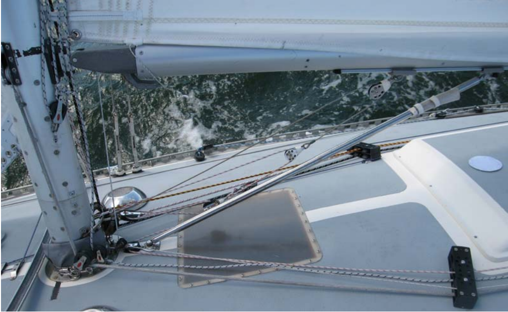
Kickstång fäster in i däck något akter om mast vilket medför att bommen trycks både uppåt och utåt. Kick 1:12.
