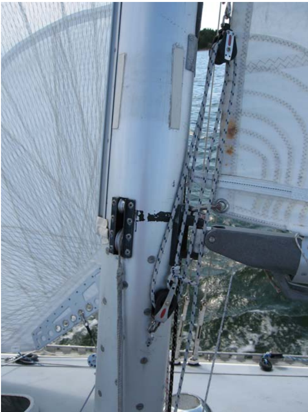
Cunningham stor 1:4 kopplas i ögla i mast och med krok o seglet. Samma ögla används vid revning av crusingstor.
