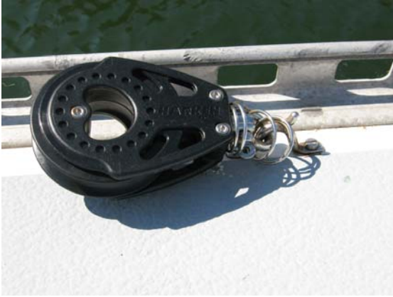
Spinnakerskot block på akterdäck med stopp svetsat till bygel för att få fjäderlasten rätt.
